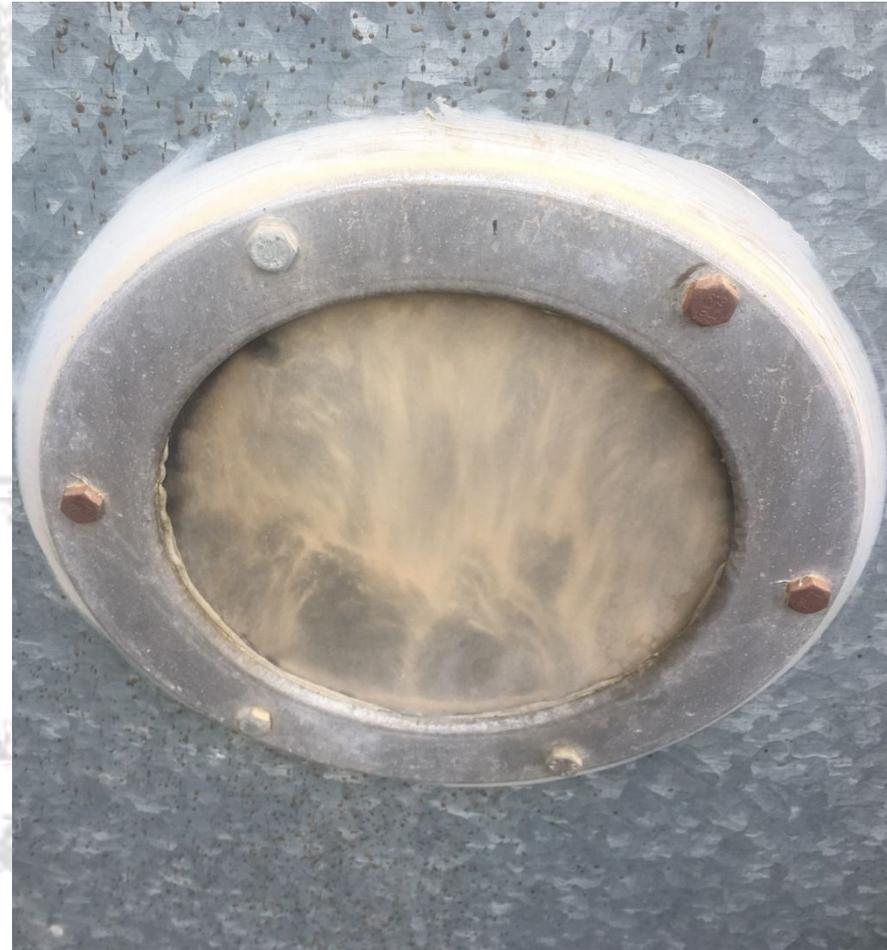
Polvo combustible que son partículas sólidas finamente divididas con un tamaño medio inferior a 500 micras, que pueden formar una mezcla explosiva con el aire en condiciones normales de presión y temperatura
